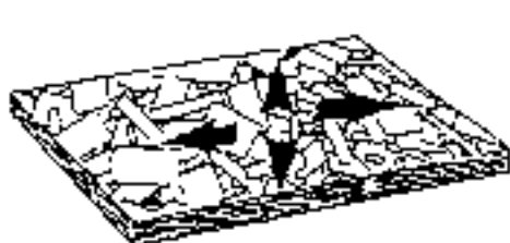
(A) Вафельно-стружечная плита с произвольным направлением волокон
